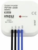
**RFIM-20B** je bežični pretvarač ulaznog signala koji menja postojeći standardni taster u bežični. Kontakt može biti trajno zatvoren (ne prazni bateriju). Može se koristiti za prenos informacije o zatvaranju kontakta (detektor, taster, logički izlaz...). Poseduje mogućnost postavljanja scena sa kojima jednim pritiskom možete da kontrolišete više iNELS RF upravljačkih jedinica.
