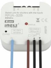
**RFJA-32B/230V** je višenamenski dvokanalni prekidački modul za roletne. Koristi se za kontrolu roletni, žaluzina, garažnih vrata, kapija, tendi itd. Može se kombinovati sa iNELS RF Control kontrolerima ili sistemskim elementima. Prekidačkom jedinicom se može upravljati do 25 kanala. Dugme PROG na modulu takođe služe za manuelnu kontrolu izlaza.
