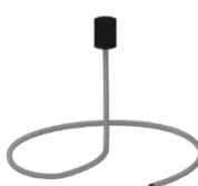
MS senzor je magnetni senzor, koji detektuje impulse prilikom obrtanja rotacionog dela na brojilu na koji je postavljen stalni magnet. Senzor za detektovanje se postavlja na brojčanik, unutar brojila. Drugi kraj senzora se povezuje na kleme unutar pretvarača impulsa RFTM-1 / AirTM-100. Posebno je pogodan za merače gase koji podržavaju magnetsko detektovanje.
