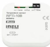
RFTI-10B je senzor temperature koji se koristi za merenje temperature pomoću integrisanog ili spoljašnjeg senzora, koji u redovnim intervalima šalje signal sistem. Meri temperaturu u opsegu od -20 do 50 °C i šalje je sistemskoj jedinici (eLAN-RF, RF-Touch) u redovnim petominutnim intervalima. Šalje signal kada se temperatura naglo promeni u roku od jednog minuta. Pored integrisanog senzora (INT. THERM) postoji opcija za povezivanje spoljašnjeg senzora temperature na terminal EXT. THERM.
