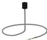
LS senzor je senzor detektuje LED impuse na električnom brojilu, koji trepere u zavisnosti od potrošnje. Posebno je pogodan za brojila za električnu energiju koja podržavaju detekciju LED impulsa (LED na meraču električne energije ima oznaku "imp"). Drugi kraj senzora se povezuje na kleme unutar pretvarača impulsa RFTM-1 / AirTM-100. Standardna dužina od 1,5 m se može produžiti do 5 m po narudžbi.
