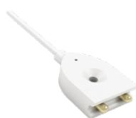
FP-1 je sonda za detekciju tečnosti. Nadgleda područja (kupatilo, podrum, šah, rezervoar, itd.) kako bi na vreme upozorio na poplavu. Koristi se u kombinaciji sa detektorom nivoa RFSF-1B ili reljem za nadgledanje nivoa tečnosti HRH-x. Fiksiranje se vrši pomoću dvostrane lepljive trake. Sonda detektuje prisutnost tečnosti preko elektrode nakon čega se prosledjuje signal na detektor nivoa ili reljem za nadgledanje nivoa tečnosti.
