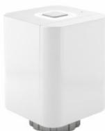
Bežična termo glava koristi se za regulaciju temperature u prostoriji. Instalira se direktno na radijatorski ventil, koji meri temperaturu uz pomoć integriranog senzora temperature i ugradenim motorom reguliše ventil radijatora.
