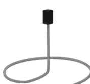
WS senzor je magnetni senzor za vodomere, detektuje impulse prilikom obrtaja magneta na rotacionom delu vodomera. Postavlja se na brojčanik vodomera. Posebno je pogodan za vodomere koji podržavaju magnetsko detektovanje. Senzor se postavlja iznad kružnog obrtnog dela na kom se nalazi magnet.
