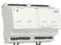
IOU3-108M je ulazno izlazni aktuator, opremljen sa 8 binarnih ulaza, 2 temperaturna ulaza i 8 nezavisnih releja. Uredaj se može koristiti za očitavanje impulsa sa brojila energije koji ima impulsni izlaz. Koristi se u slučajevima kada je potrebno izmeriti temperaturu, npr pod/temperaturu prostorije, unutrašnju/spoljašnju temperaturu, temperaturu kotlarnice, solarnog grejanja, itd. Svaki od izlaznih kontakta može se pojedinačno kontrolisati i adresirati.
