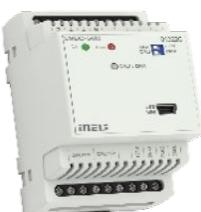
Uredaj EMDC-64M je dizajniran za kontrolu DALI i DMX rasvete iz iNELS sistema. Omogućava kontrolu do 64 nezavisne DALI svetiljke. EMDC-64M takođe omogućava povezivanje do 32 prijemnika DMX (Digital MultipleX) u jedan segment. Kada se koriste pojačivači mogu da kontrolišu do 64 uređaja. Maksimalna količina DMX kontrolisanih kanala je 64 kanala.
