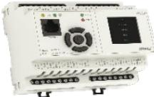
**CU3-01M** je centralna jedinica iNELS sistema i posrednik, između korisničkog softvera i kontrolera, senzora i prekidačkih modula povezanih na BUS. Moguće je direktno povezati dve BUS linije na CU3-01M, a na svaku liniju možemo povezati 32 iNELS uređaja (ukupno 64 uređaja).
