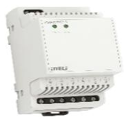
**PS3-30/iNELS** je stabilizovano napajanje za iNELS BUS sistem sa maksimalnom snagom do 30 W. Koristi se za napajanje iNELS BUS sistema. Sadrži integrисани bus separator BPS3-01M.
